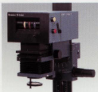
Le déplacement vertical de la tête se fait vite, au millimètre près, grâce à une poignée moletée à couplage rapide. Un ressort contrepoids compense le poids de la tête. La colonne est graduée en centimètres et en inch; elle comporte également une échelle de facteurs d'agrandissement qui permet de répéter rapidement un réglage sur un format déterminé.
